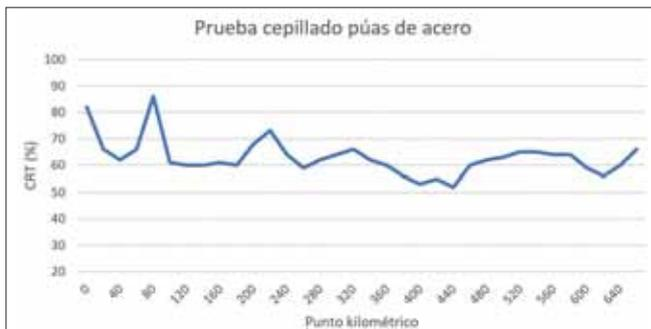
Figura 8. Valores de CRT obtenidos con equipo SCRIM tras cepillado con barredora de púas de acero
