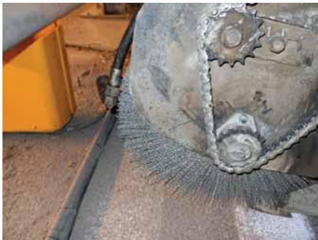
Figura 6. Barredora de púas de acero utilizada
