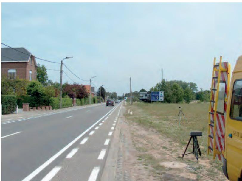
Figura 22. Método del paso estadístico (SPB) [2]
