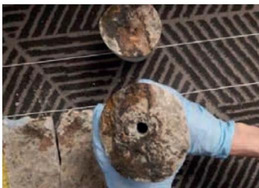
Figura 14. Aspecto del óxido observado en uno de los testigos extraídos en la traza de la fisura para su examen visual
