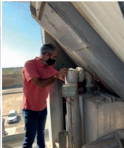
Fotografías 3 y 4. Introducción manual de aditivos sólidos en la mezcladora (izquierda) y líquidos en la báscula del betún (derecha)
