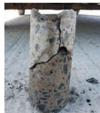
Figura 10 - Fracturación interior de la masa de hormigón en uno de los testigos extraídos en la estructura de la carretera SG-20ra SG-20)
