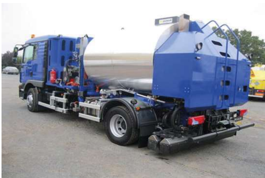
Figura 10. Camión cisterna con rampa de riego abatible.
