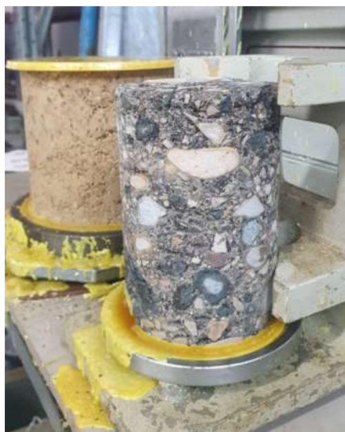
Figura 17. Ensayo de resistencia a compresión sobre testigos
