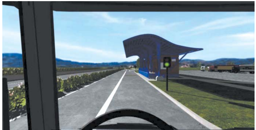
Figura 9. Semáforo que indica que se puede proceder al pesaje estático o de baja velocidad. Fuente: " Eptisa. "Infografía. Estaciones de Pesaje".
