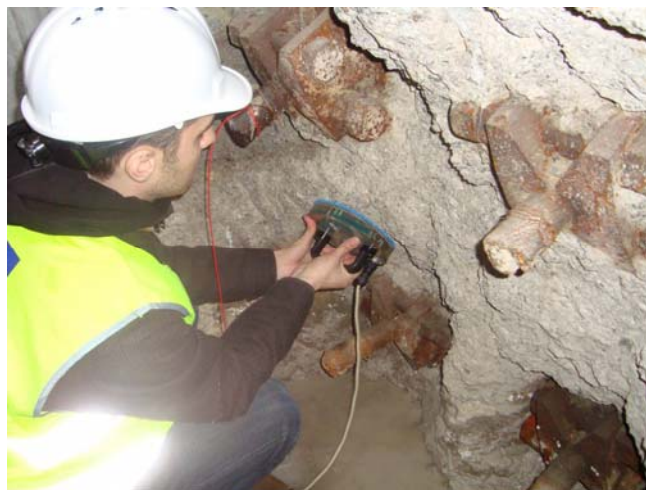
Figura 22. Medición de potencial en cabezas de cable de retenida embebido en hormigón - puente colgante.
