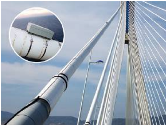
Figura 25. Acelerómetro en el puente Rion Antirion.
