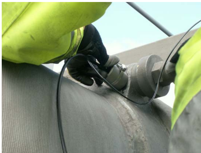
Figura 24. Puente sobre el estuario del Forth - Escocia. Acelerómetro de sistema auscultación acústica desarrollado por advitam.
