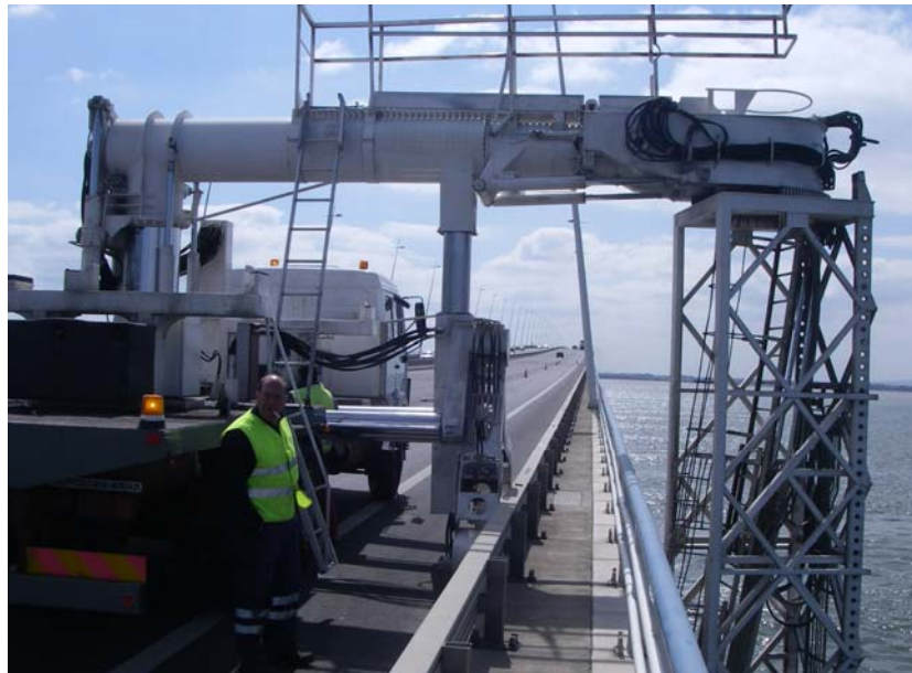
Figura 16. Camión con plataforma de acceso inferior telescópica – Puente Vasco de Gama – Portugal.
