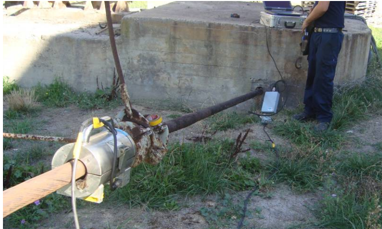
Figura 21. Medición de flujo magnético en cables de puente colgante - Huesca
