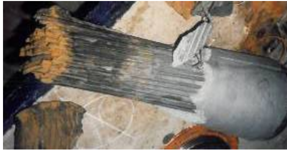
Figura 30. Detalle de la falla del tirante roto en Zárata
