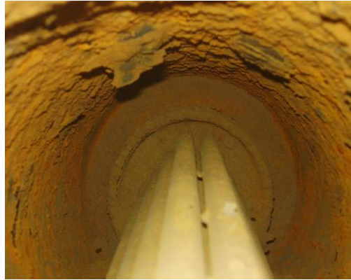
Figura 5. Corrosión de la cara interior de tubo de encofrado no galvanizado
