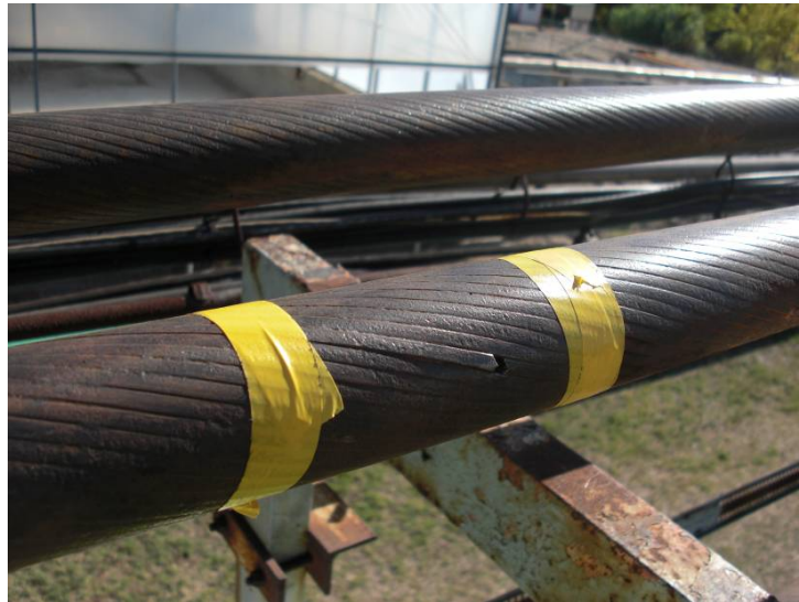
Figura 13. Rotura de hilos periféricos con reanclado
