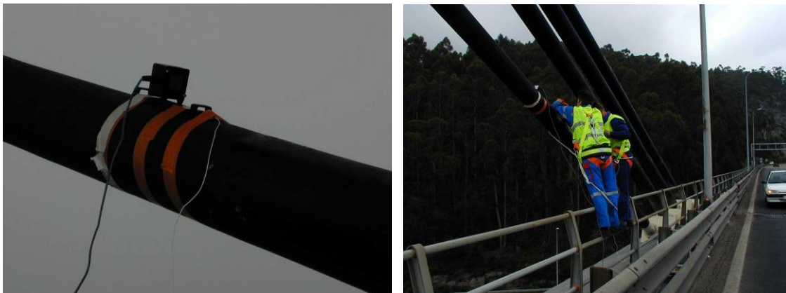
Figura 19. Método de la cuerda vibrante en el Puente Barrios de Luna
