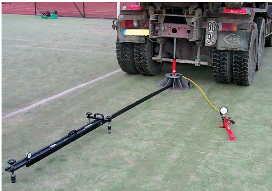
Ejecución de un ensayo de carga mediante placa estática
