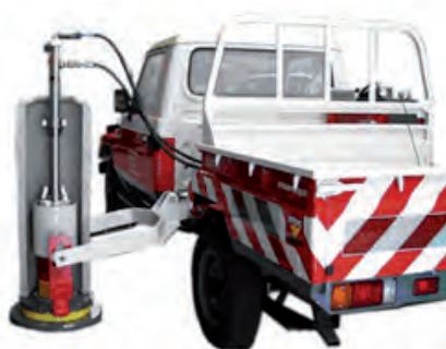
Método 1: placa rígida 2r = 600 mm (UNE 103807 - 1). Esquema general y vista del equipo (fuentes: norma española y LCPC)
