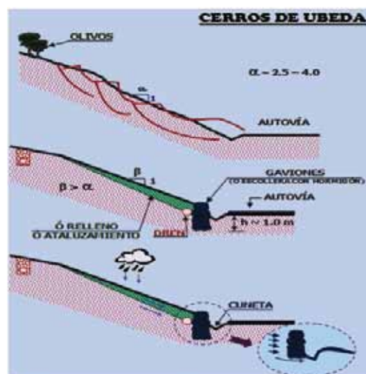
Figura 18. Inestabilidad superficial en desmonte de los Cerros de Úbeda.
