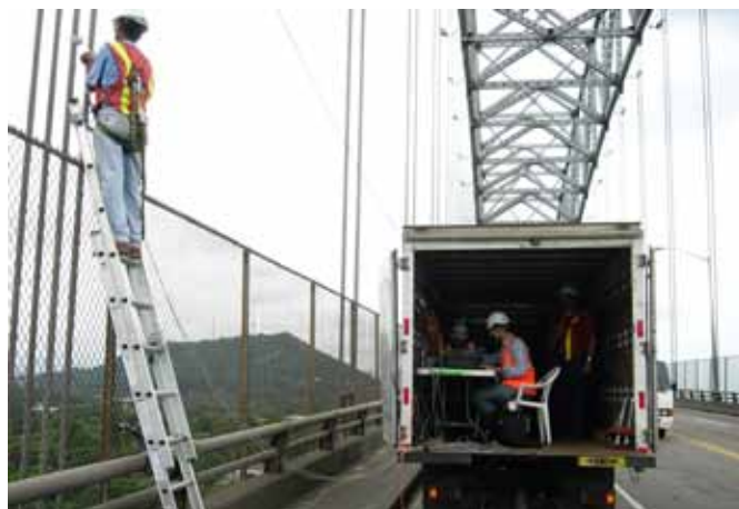
Figura 19. Medición de cuerda vibrante del puente las Américas
