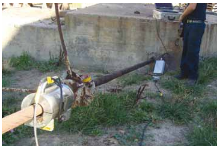
Figura 21. Medición de flujo magnético en cables de puente colgante - Huesca
