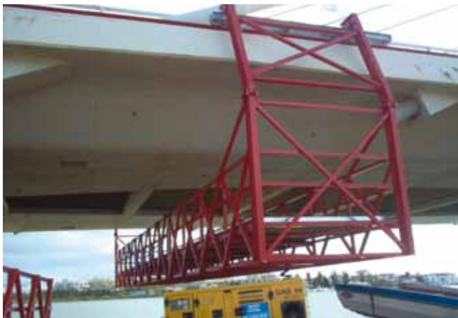
Figura 15. Pasarela inferior motorizada en el puente de Arade – Portugal
