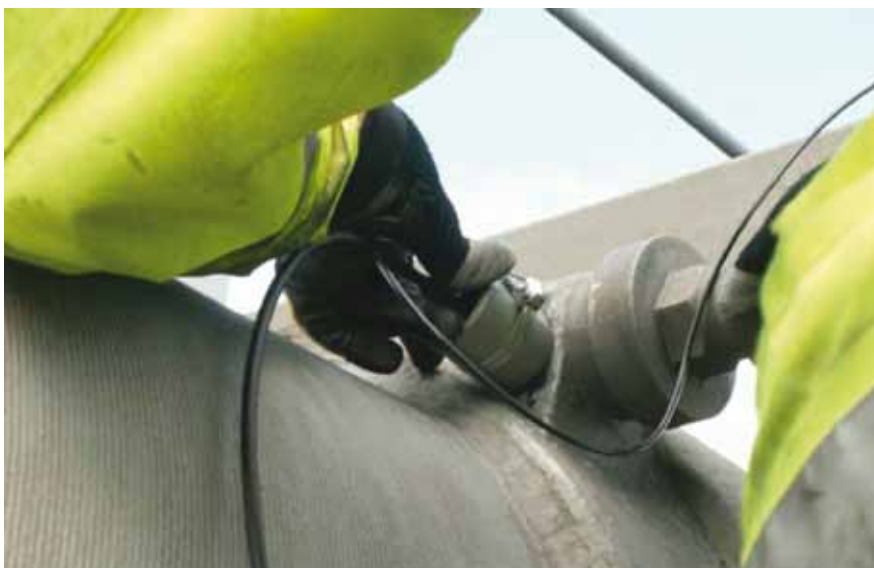
Figura 24. Puente sobre el estuario del Forth - Escocia. Acelerómetro de sistema auscultación acústica desarrollado por advitam
