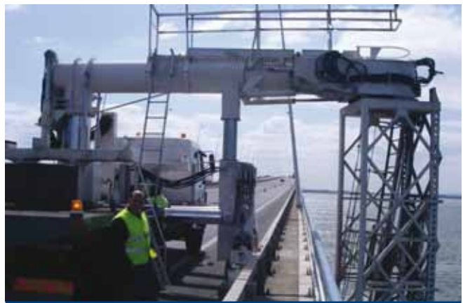
Figura 16. Camión con plataforma de acceso inferior telescópica – Puente Vasco de Gama – Portugal
