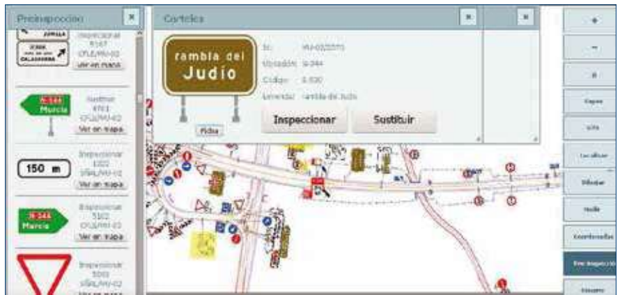
Figura 13. Aspecto de la pantalla de preinspección de señalización vertical sobre tableta de SIGex
