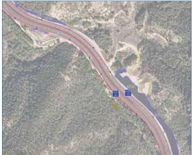
Figura 5. Representación gráfica del inventario de taludes empleando elementos superficiales tipo polilínea cerrada para delimitar el perímetro
