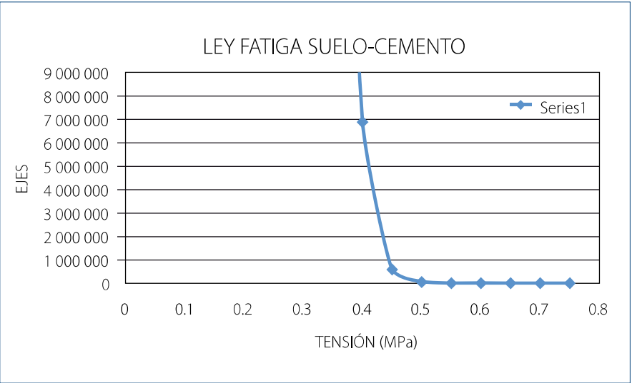
Figura 10. Representación de la ley de fatiga del suelo-cemento [3]
