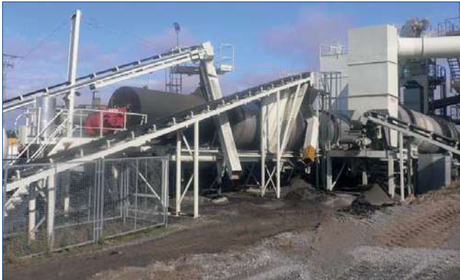
Figura 5. Instalación asfáltica de tipo discontinuo con tambor secador independiente para el material fresado
