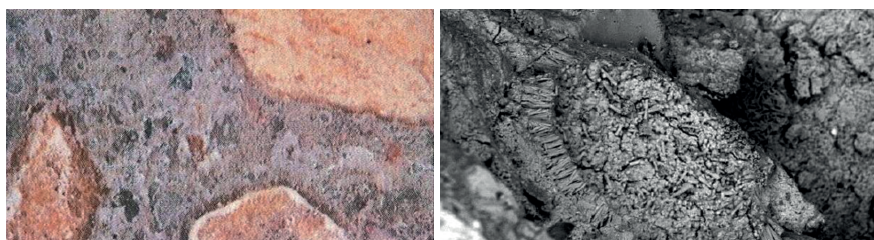
Figura 16. Aspecto de los geles detectados en la microscopía (A la izquierda, estructura del Nudo de Colmenar, a la derecha, estructura de la carretera SG-20)
