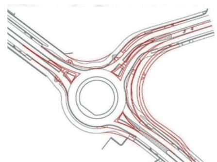
Figura 3. Correcciones en la geometría para mejorar el diseño. Fuente: Price y Rust, 2011
