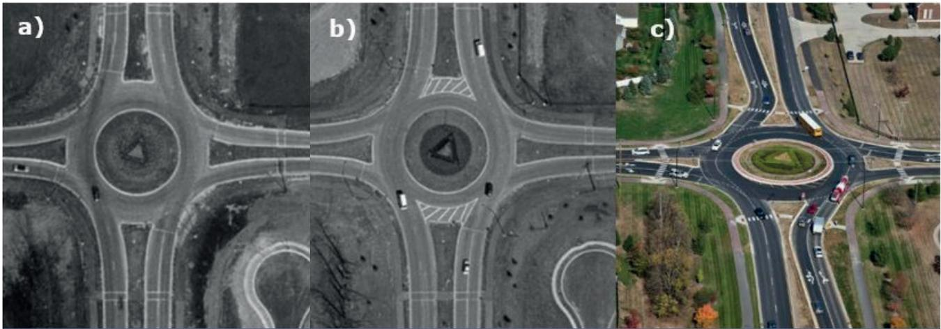
Figura 4. Correcciones del trazado y de la señalización (a) la situación original (b) modificación de la señalización (c) modificación de la geometría. Fuente: Vorisek (2011)
