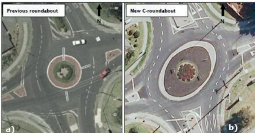
Figura 8. Modificación de la tipología hacia una C-glorieta (a) la situación original (b) el diseño modificado. Fuente: Campbell et al. 2012
