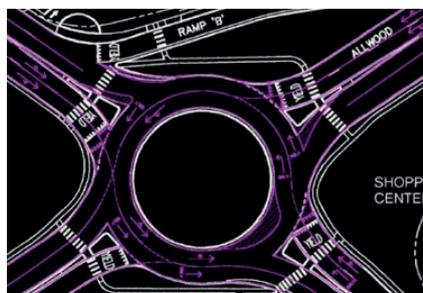
Figura 6. Mejora de la funcionalidad mediante nueva señalización horizontal aprovechando el espacio existente. Fuente: McCulloch, 2011
