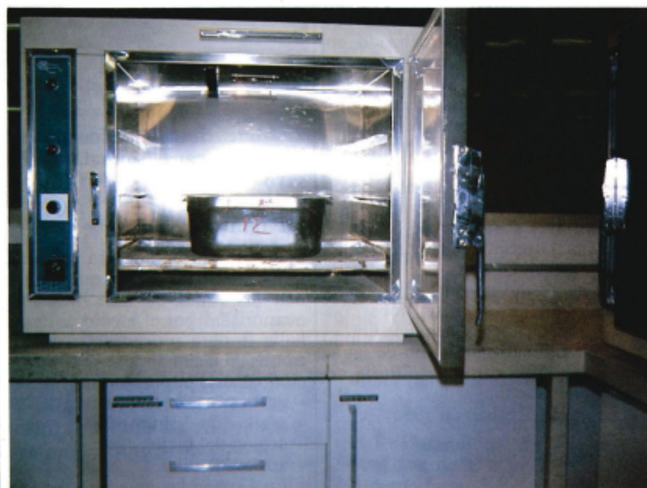
Ensayo de meteorización. Material en estufa de desecación
