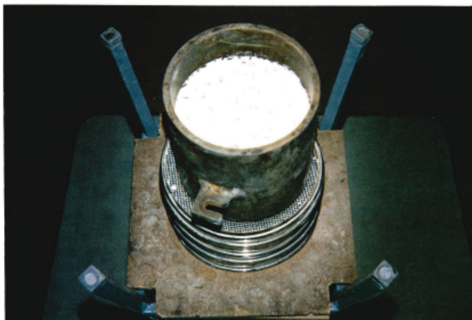
Ensayo de permeabilidad. Probeta conteniendo el material
