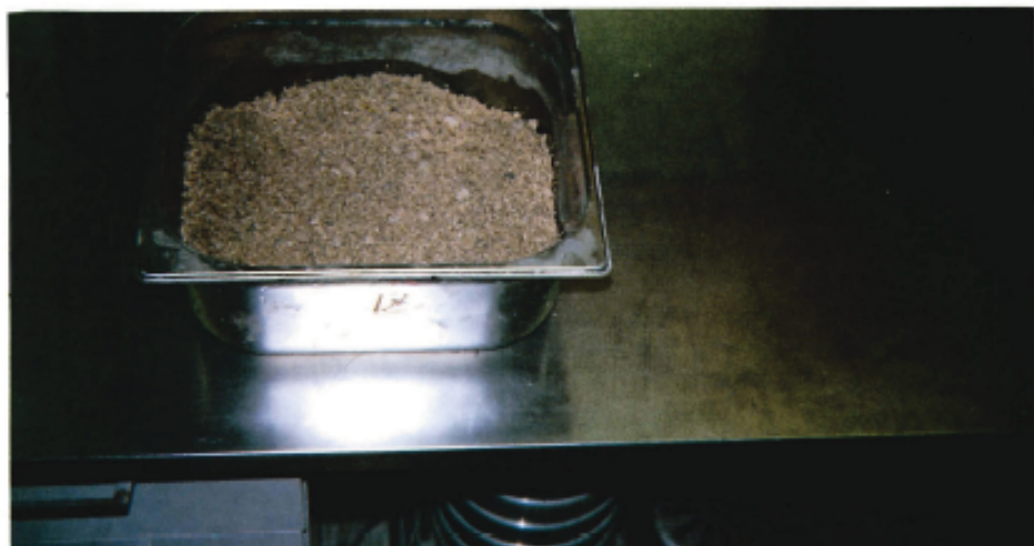
Ensayo de meteorización. Material sumergido en agua
