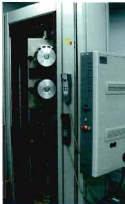
Ensayo de tracción para probetas anchas UNE - EN ISO 10319. Laboratorio de Ensayos de Geosintéticos de la Universidad de Cantabria (LAGUC).
