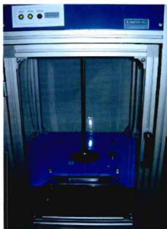
Ensayo de perforación dinámica (caída de cono). UNE - EN 918. Laboratorio de Ensayos de Geosintéticos de la Universidad de Cantabria (LAGUC).
