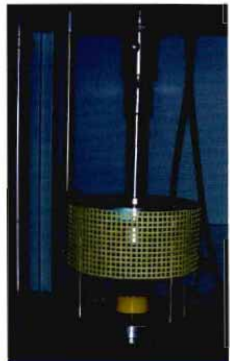
Ensayo de punzonado estático UNE - EN ISO 12236. Laboratorio de Ensayos de Geosintéticos de la Universidad de Cantabria (LAGUC).
