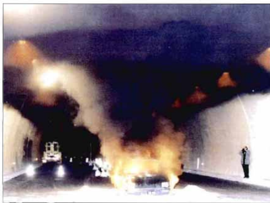
Figura 3. Incendio experimental de un vehículo ligero en un túnel de autopista cerca de Mónaco. Tomado de PIARC, 1999.
