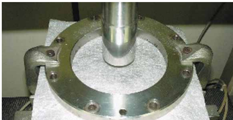
Ensayo de punzonamiento estático (CBR) de un geotextil no tejido.
