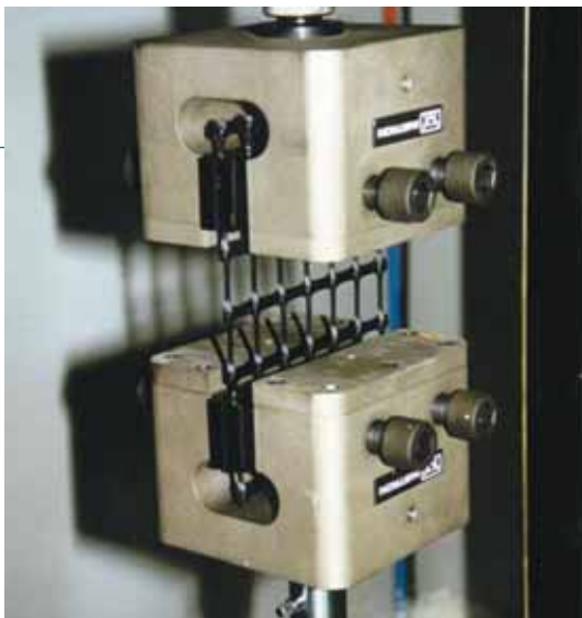
Ensayo de resistencia a tracción de una geomalla.
