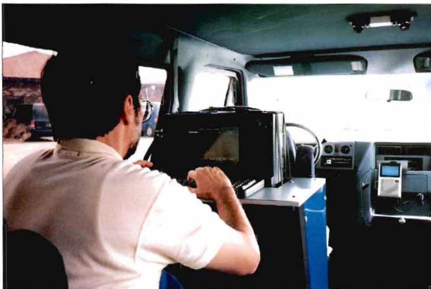
Interior del vehículo retrorreflectómetro móvil para marcas viales. Estación de trabajo del operador.
