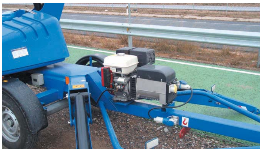
Figura 3. Generador eléctrico del Laboratorio Móvil de Tráfico.
