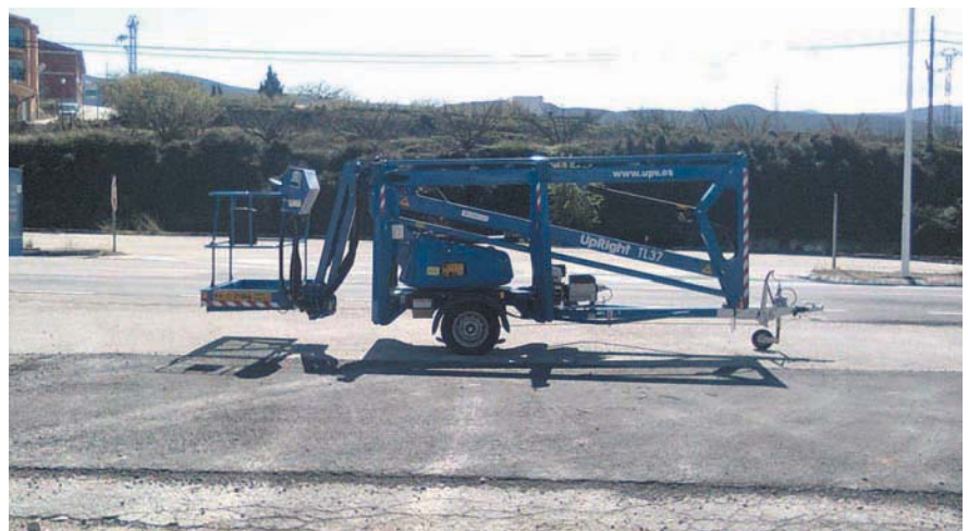
Figura 2. Plataforma elevadora en posición de transporte.
