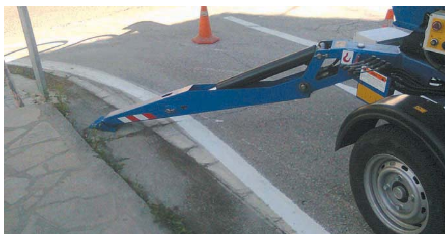
Figura 5. Apoyo de la plataforma elevadora.
