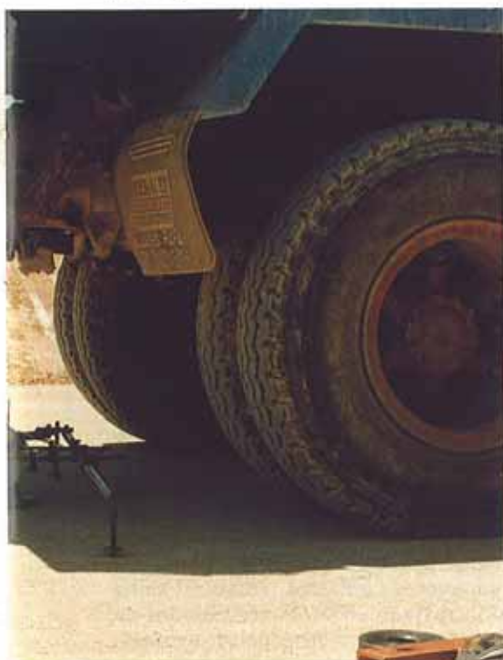
Control de compactación de suelos. Placa de carga.
