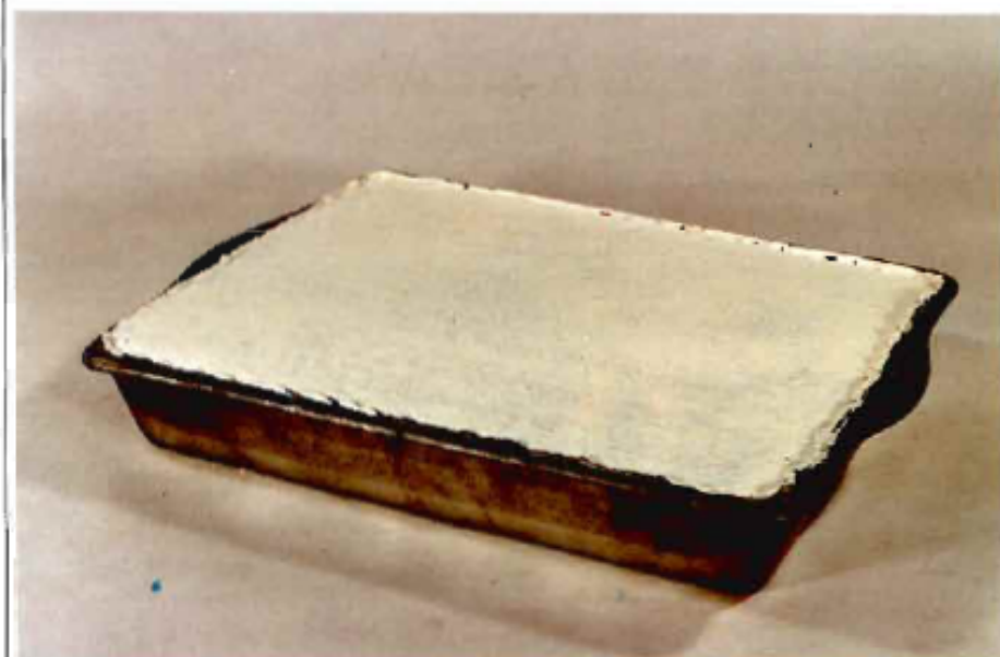
Foto 2. Molde con probeta y producto de curado.
