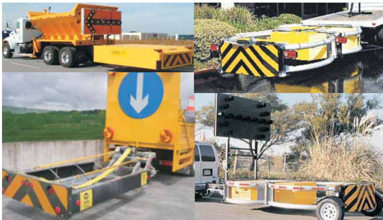
Atenuadores de impacto acoplados a vehículos.
