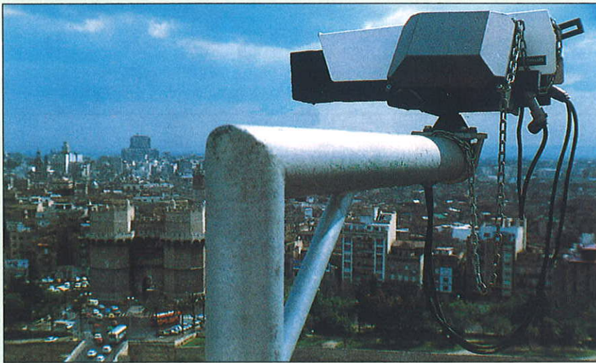
Cámara de televisión instalada para el control de tráfico.
