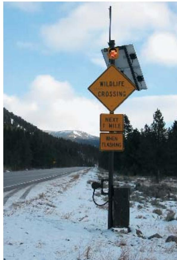
Los sistemas de teledetección y aviso de presencia de fauna tienen un fuerte componente electrónico y requieren de un cuidadoso programa de mantenimiento, especialmente en condiciones atmosféricas adversas.
