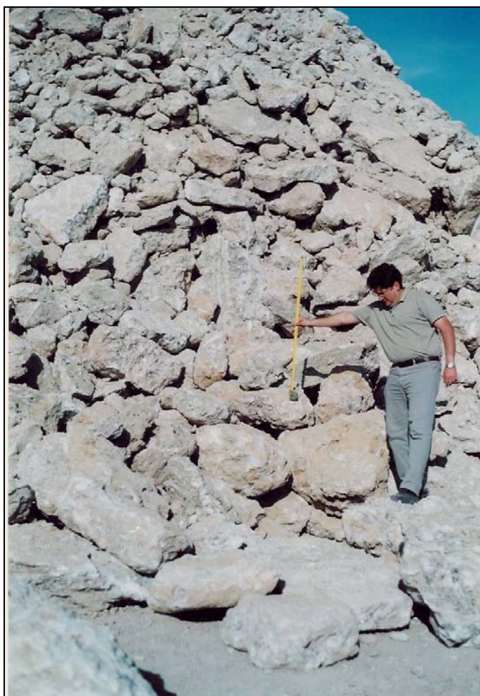
Foto n° 3.- Distribución de tamaños obtenidos en una zona volada y retirada a vertedero
