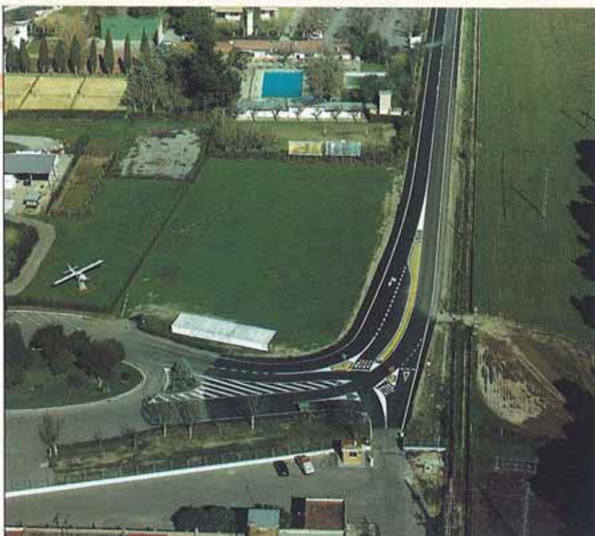
El trazado proyectado en planta es una sucesión de alineaciones rectas y curvas circulares, con clotoides de acuerdo en el tramo interurbano.
