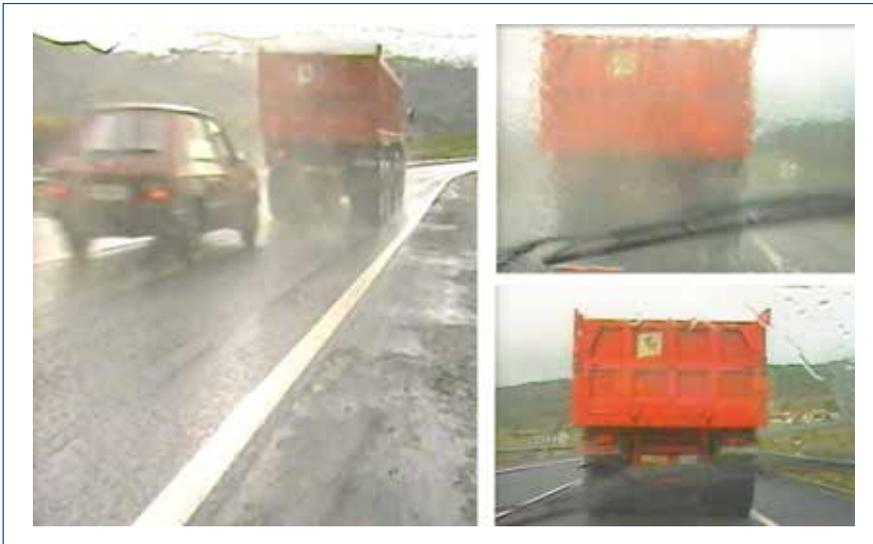
Figura 1. Circulación con lluvia. Pavimento poroso. Eliminación de salpicaduras.
