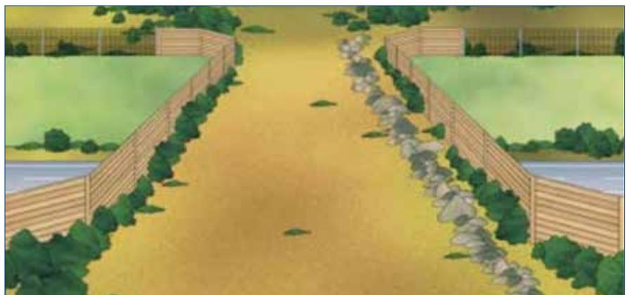
Figura 9. Diseño de un paso superior específico para la fauna
