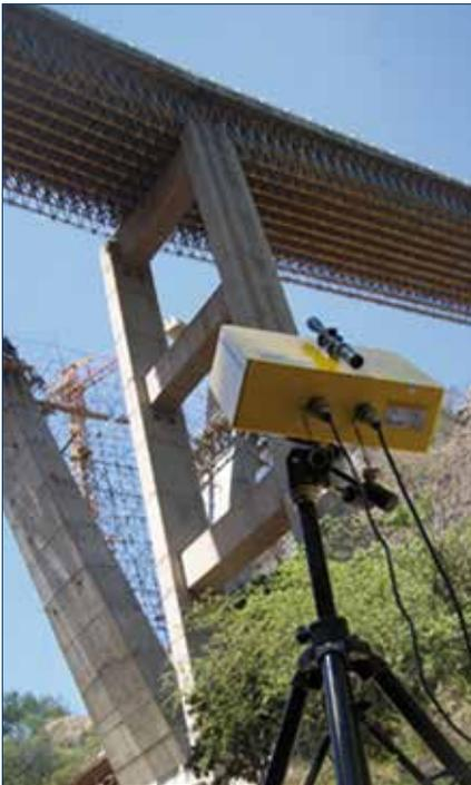
Figura 1. Sistema Radar Doppler para la monitorización dinámica de puentes.
