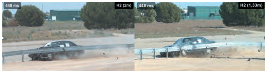
Figura 6. Ensayos sobre sistemas H2 con poste cada 2 y 1,33 m. Los sistemas contienen al vehículo.
