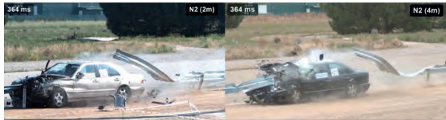
Figura 4. Ensayos sobre sistemas N2 con poste cada 2 y 4 m. Se observa la rotura completa de la valla en ambos casos.
