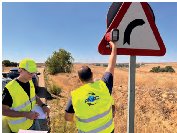
Figura 3. Medida del coeficiente de retrorreflexión mediante equipo estático durante los trabajos de intercomparación
