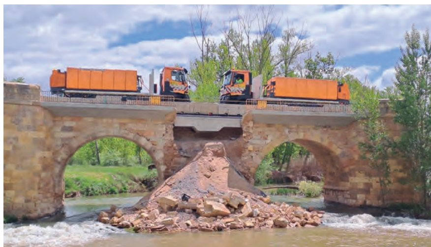
Figura 10. Vista de la prueba de carga realizada sobre la estructura una vez ejecutado un puente interior de hormigón armado.
