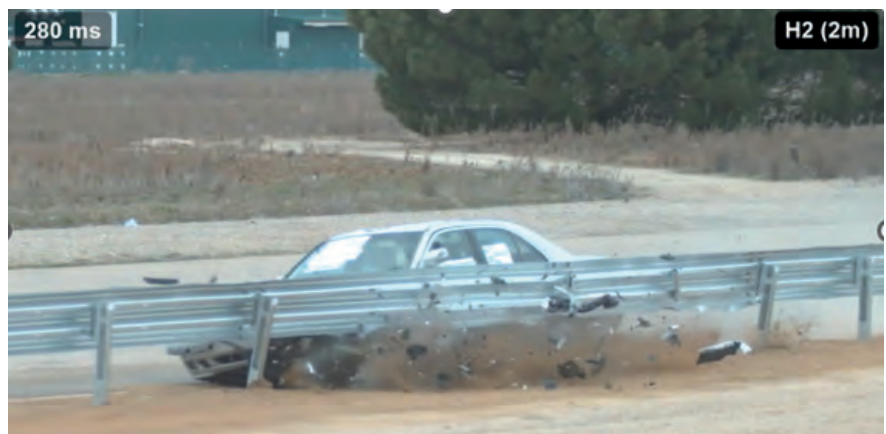
Figura 7. Ensayo sobre sistema H2 trionda. El sistema contiene y redirige adecuadamente al vehículo.
