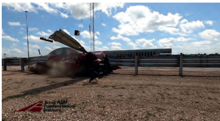
Figura 10. Ensayo Tesla Model 3 contra sistema Trionda realizado por el TTI. Se observa la rotura completa de la valla.
