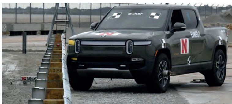
Figura 9. Ensayo con vehículo Rivian .R1T realizado por el Midwest Roadside Safety Facility (MwRSF) de la Universidad de Nebraska
