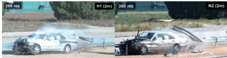
Figura 5. Ensayos sobre sistemas N2 y H1 con poste cada 4 m. Se observa la rotura completa de la valla en ambos casos.
